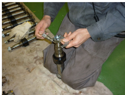
写真 3-4-2 マイクロメータによる寸法測定
