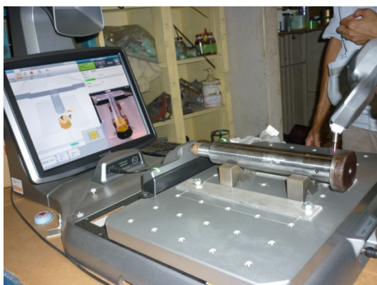
写真 3-4-1 3次元画像解析による寸法測定
