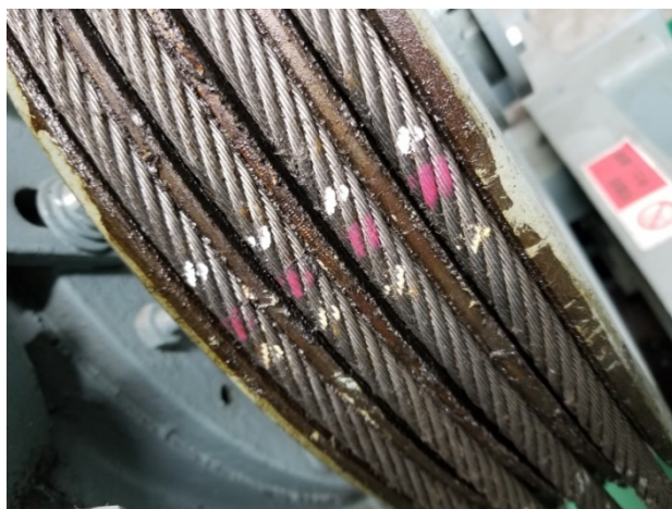
写真 1-11-1 測定範囲を示す印（チョーク）の例
