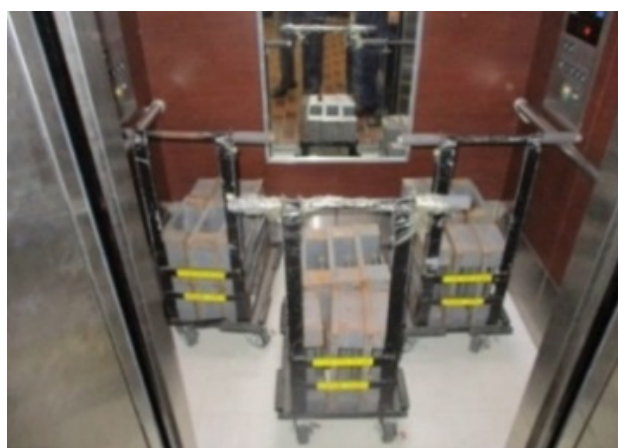
写真 1-14-1 実際にウェイトを載せて検査している例
