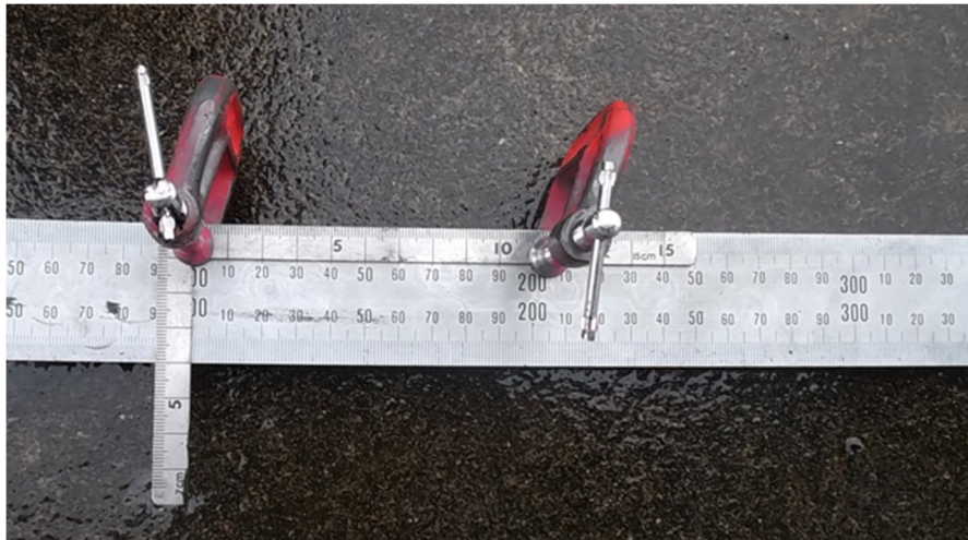
写真 3-3-2 金尺を利用したチェーンの伸びの測定
