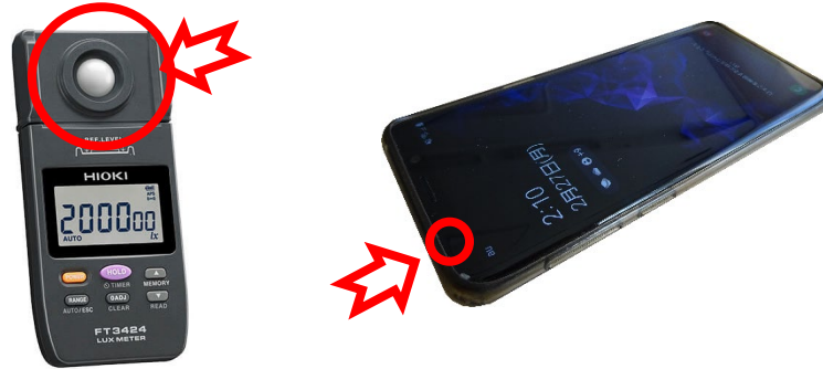
照度計とスマートフォンの照度センサの受光面
