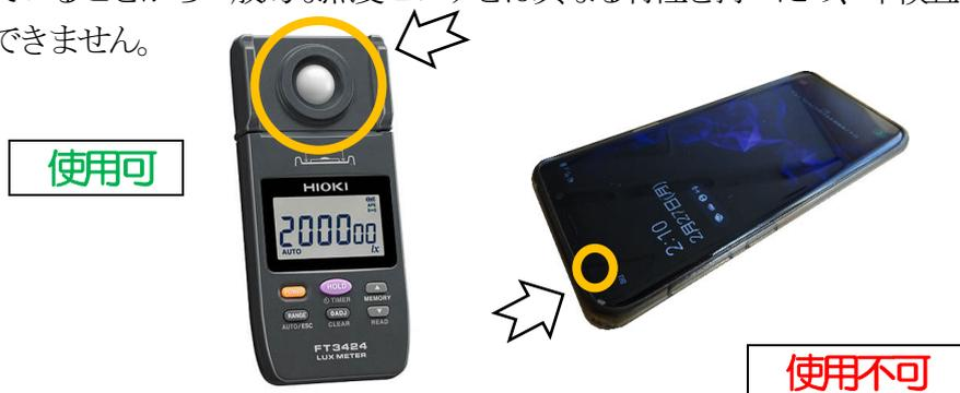
写真2 照度計とスマートフォンの照度センサの受光面の違い
